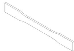
Géométrie ASTM D638 Type I sans fibre
